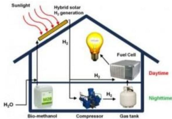
Ilustración 25. Esquema funcionamiento panel solar híbrido de hidrógeno. Fuente: Eraikal.
