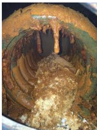
Ejemplo real. Interior depósito ACS sin el correcto mantenimiento
